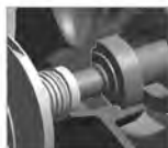
Торцевое уплотнение вала
