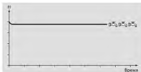
Работа TECNOPLUS – стабильное давление в системе при изменяющемся расходе воды.
