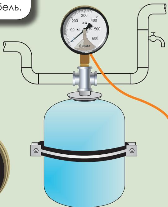
Установите АДМ-100.3 с подключенным кабелем на водопровод.
