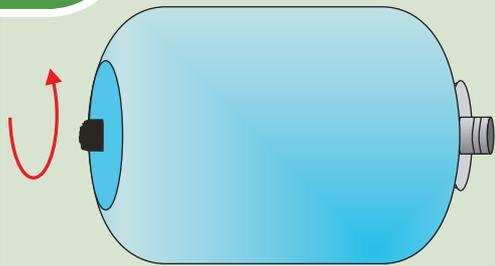
Перед началом монтажа, проверьте давление в гидроаккумуляторе, при необходимости накачайте гидроаккумулятор.
