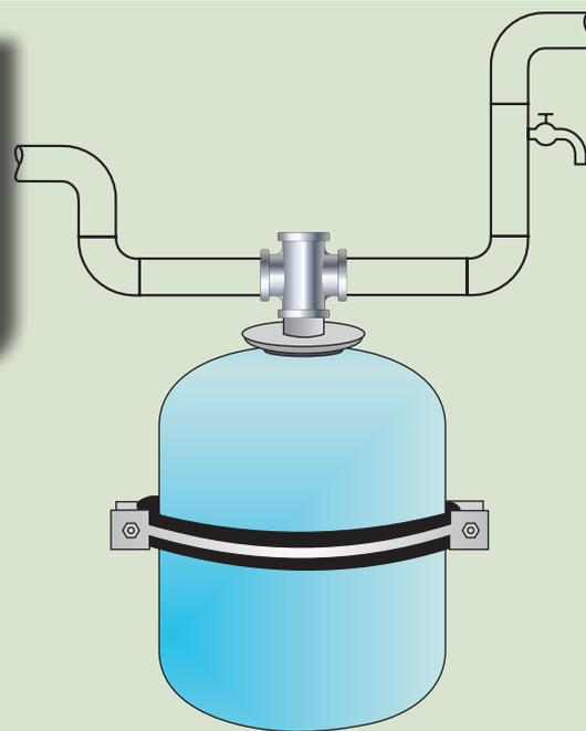
При монтаже водопровода подключите к нему гидроаккумулятор.
