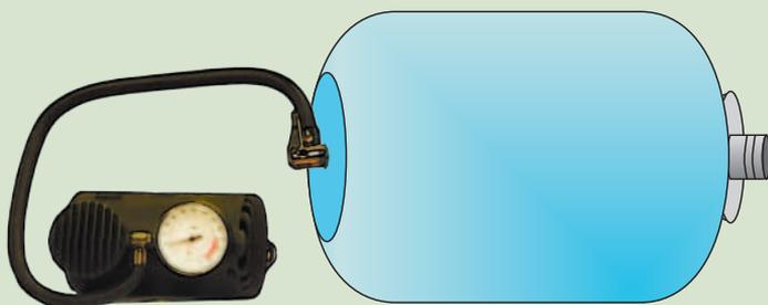
Давление в гидроаккумуляторе должно быть 75% от рабочего давления (при рабочем давлении 3 атм. (заводская установка), давление в гидроаккумуляторе должно быть не менее 2 атм.)
