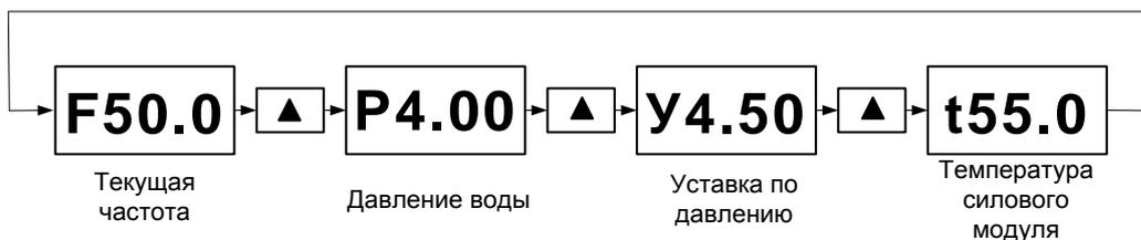
Рисунок 2 – Последовательность просмотра текущих параметров
