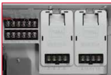
Конфигурация на 12 станций с модулями по (2) 4 станции
